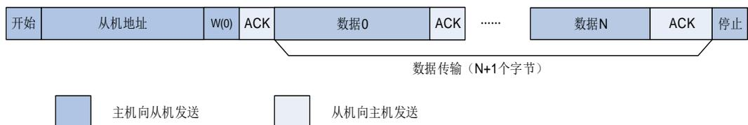
**图 26-6. 7 位地址的 I2C 通讯流程（主机接收）**
