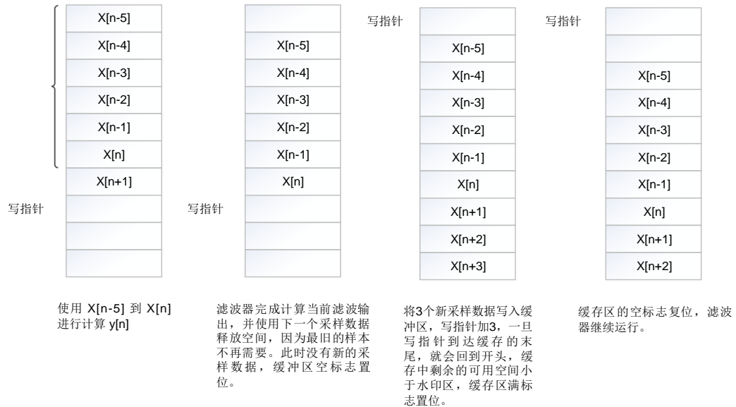
图 35-4. 循环输入缓冲区区域
