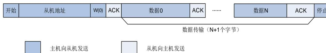
图 16-6. 7 位地址的 I2C 通讯流程（主机接收）
