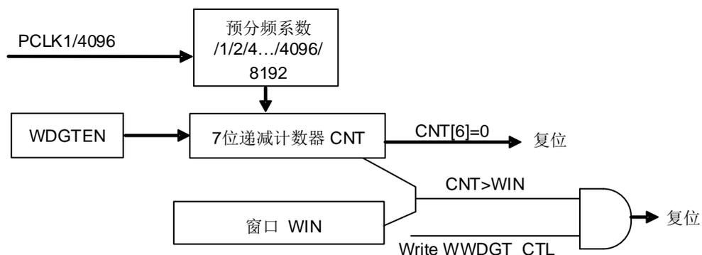
上电复位之后窗口看门狗定时器总是关闭的。软件可以向WWDGT\_CTL的WDGTEN写1开启窗口看门狗定时器，除非通过重置，否则不能再次被关闭。当通过硬件选择窗口看门狗时，看门狗定时器复位后一直处于开启状态，不能关闭。窗口看门狗定时器打开后，计数器始终递减计数，计数器配置的值应该大于0x3F，也就是说CNT[6]位应该被置1。CNT[5:0]决定了两次重
